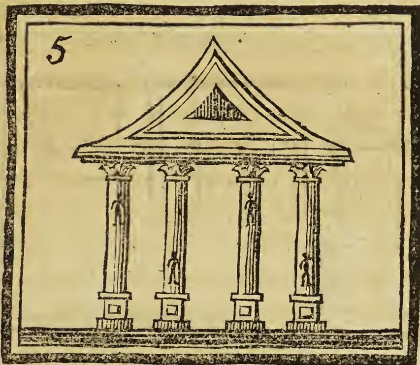
Quatre tuyaux de verre , disposés en colonnade , & surmontés d'un fronton , représentent le frontispice d'un palais. Ces colonnes transparentes & remplies d'eau , laissent apercevoir de petites figures de cire qui nagent dans l'inté-
