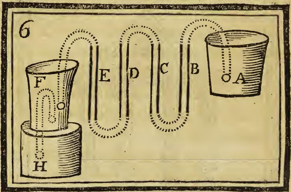
Au point *A*, est un bassin caché dans le corps du bâtiment, les quatre colonnes ne font qu'un seul & même tuyau de verre, recourbé comme le représente la figure; c'est, à proprement parler, un syphon par où l'eau s'écoule du bassin *A* au bassin *F*, qui est pareillement caché dans le corps du bâtiment.
